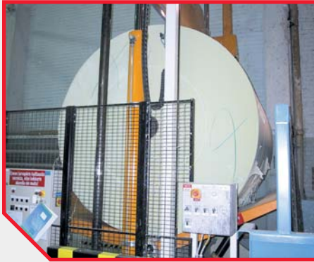
Rollerilla rullan keskitys leikkuriin.
